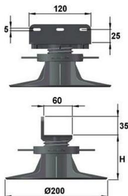
Специально оптимизированные для строительства террас с использованием лаг, опоры Forest Style позволяют производить укладку террасной доски быстро и легко.
